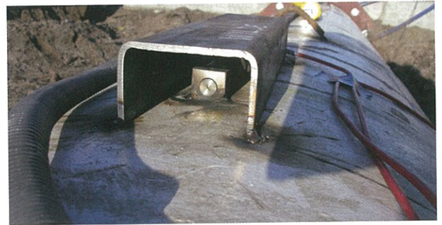
Rys. 13. Tensometr strunowy zainstalowany na rozporze
